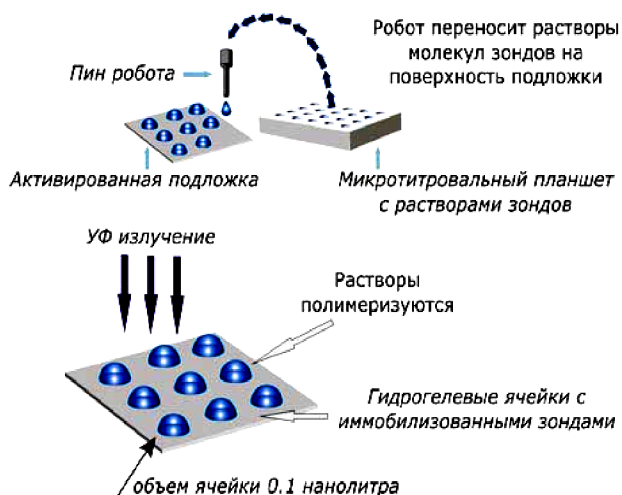
Рис. 11. Схема изготовления матричного биочипа с иммобилизованными зондовыми макромолекулами.
