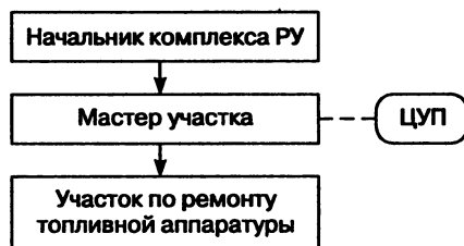
Рис. 2.4. Схема управления участком по ремонту топливной аппаратуры с использованием ЦУП: — административное подчинение; - - - оперативное подчинение
