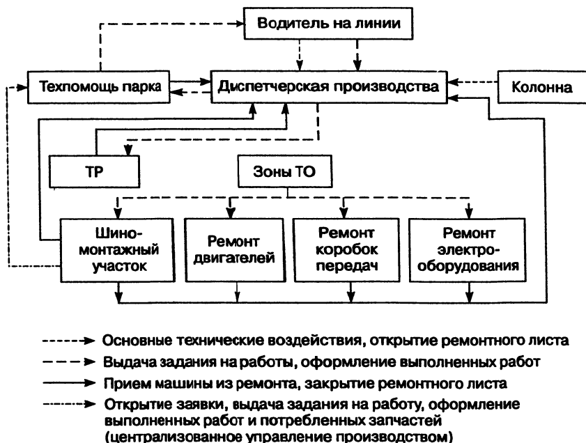
Рис. 6.1. Организация и управление производством ТО и ремонта подвижного состава
