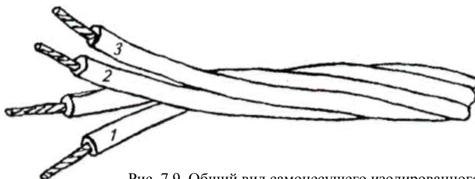
Рис. 7.9. Общий вид самонесущего изолированного провода
