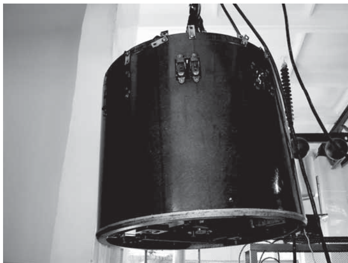
Рис. 1.28. Внешний вид погружного цилиндра контактора РПН типа SDV.
