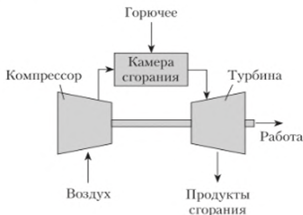
Рис. 13.12. Схема газотурбинной установки открытого типа
