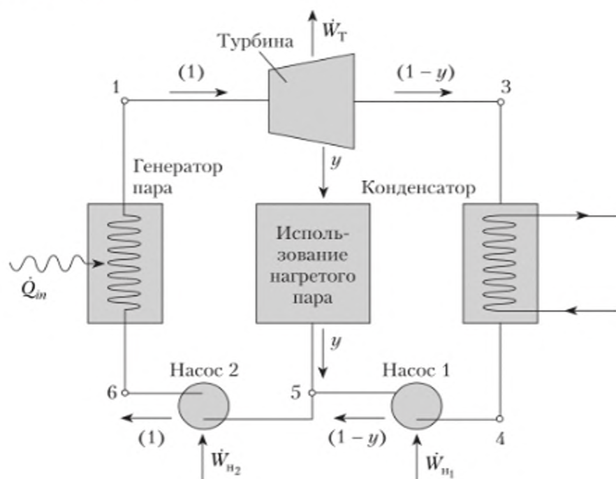
Рис. 12.17. Схема теплофикационного цикла
