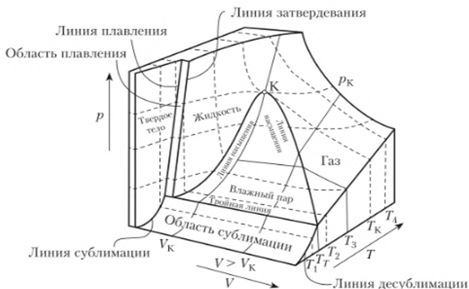
Рис. 10.15. Термодинамическая поверхность состояния чистого вещества
