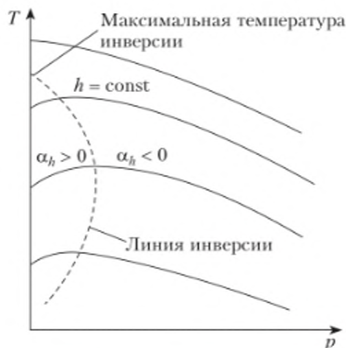
Рис. 10.28. Изоэнтальпы на T-p диаграмме
