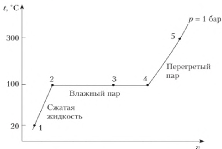
Рис. 10.2. Нагрев воды на T-v диаграмме
