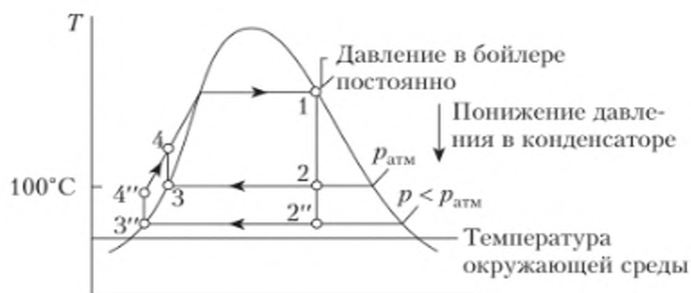
Рис. 12.8. Влияние давления в конденсаторе на эффективность цикла Ренкина
