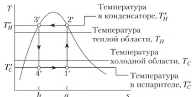
Рис. 14.2. Реальный и идеальный циклы Карно в координатах T-s
