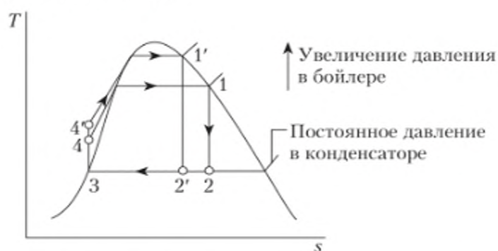
Рис. 12.7. Влияние давления в паровом котле на эффективность цикла Ренкина
