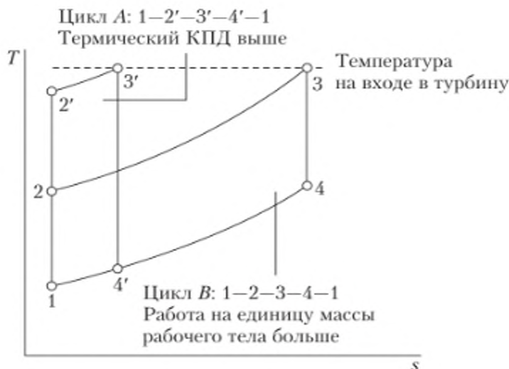
Рис. 13.18. Идеальный цикл Брайтона с одним значением температуры и разными давлениями
