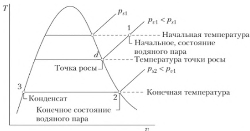
Рис. 18.7. Охлаждение влажного воздуха в координатах T-v
