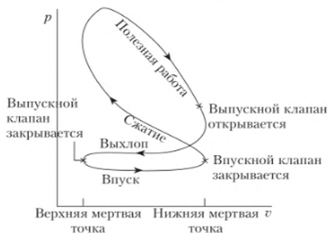
Рис. 13.1. Индикаторная диаграмма цикла Отто
