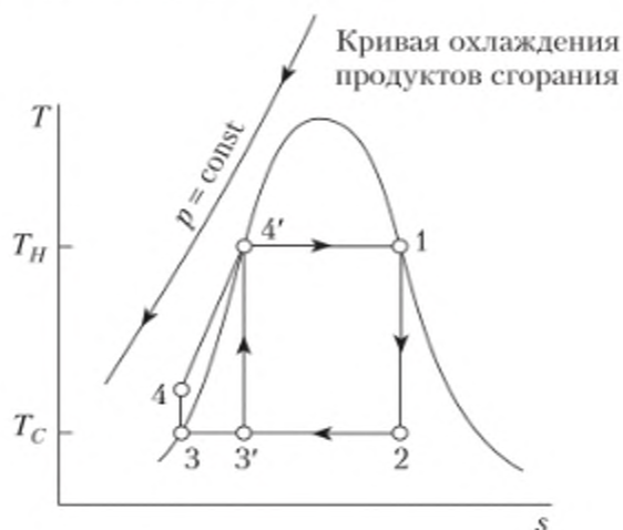
Рис. 12.9. Сравнение циклов Карно и Ренкина
