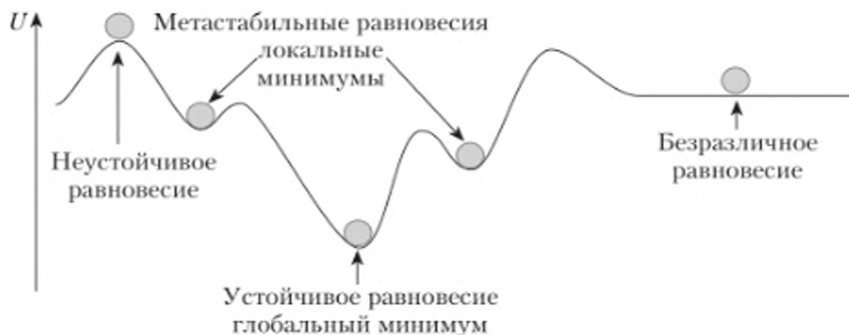
Рис. 15.2. Устойчивые и неустойчивые состояния системы
