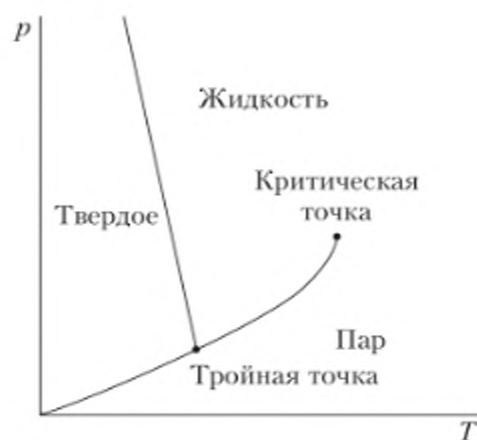
Рис. 10.13. Фазовая диаграмма воды в координатах p - T
