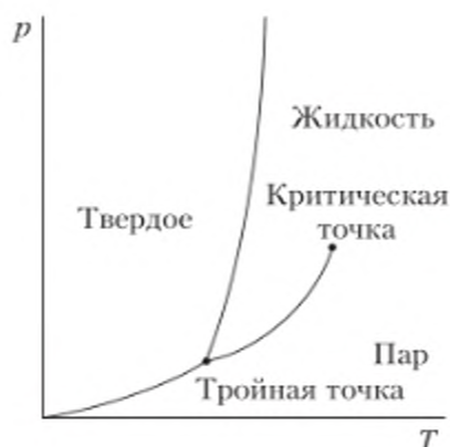
Рис. 10.14. Фазовая диаграмма вещества в координатах p – T
