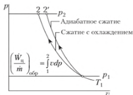
Рис. 13.23. p-v диаграмма цикла компрессора:
